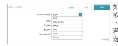
如果您的网络类型为固定IP地址或路由器无法侦测到何种类型时, 会出现此画面让您手动选择。若您申请的网络为固定IP时, 请选「固定IP地址连线」后按「下一步」。
