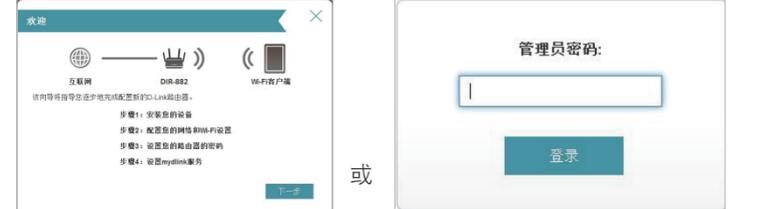
此网页是连至路由器的内部设定接口, 在无法连通网络时也可以打开。若无法打开时, 请检查计算机是否已通过有线或无线方式联机至路由器(有线连至1-4端口), 或参考第10页的常见问题来检查设置。
