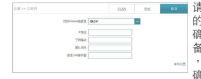
请在栏位内输入网络服务商提供的IP地址相关数据并确认数据正确后按「下一步」。备注: 画面中的数据为设定范例, 请勿输入相同的数据。若您不确定应该输入什么数据时, 请与您的网络服务商联络。
