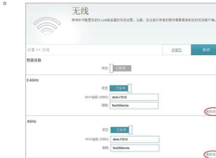
从「信道」项目的下拉式菜单更改信道的数字，按下右上方「保存」后再重新连接。建议您使用检测无线网络的程序或app来查看附近无线设备使用的信道，再选择较无干扰或重复的频道。若您的设备仅支持特定频道，请选择可支持的信道使用。若您不清楚该用什么信道时可任意选择2-3个信道来测试。
